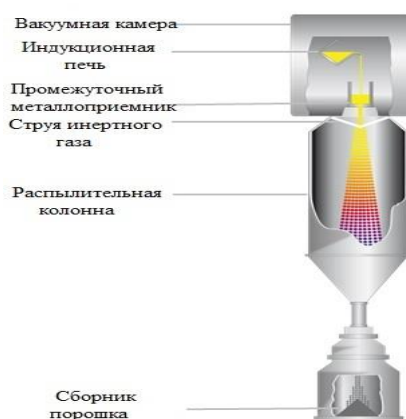
2.2-сурет-Вакуумдық-индукциялық балқытылған атомайзер сұлбасы
